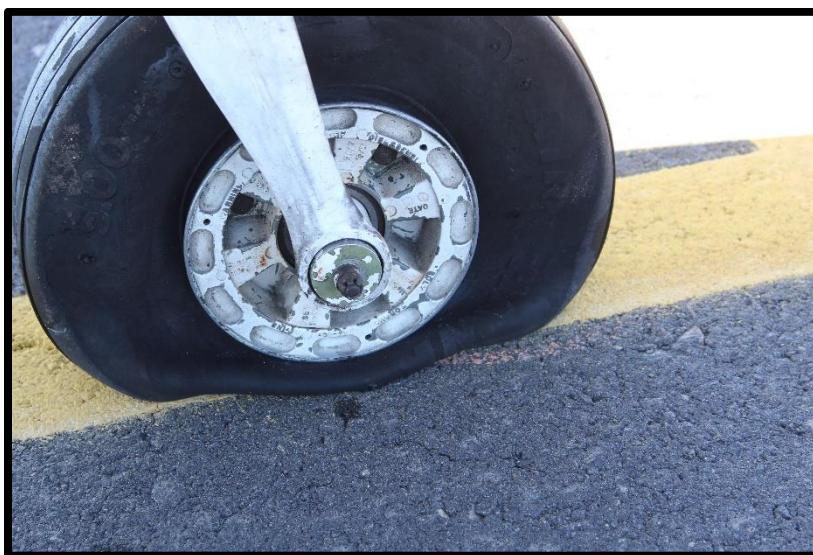
Fotografía No. 4 Condición de la rueda de nariz.
