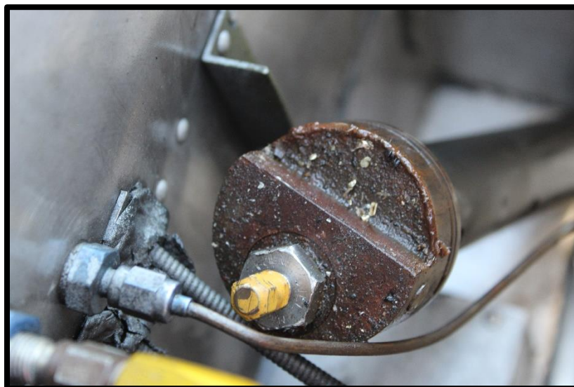
Fotografía No. 11 Cilindro interno del amortiguador desplazado de su posición.
