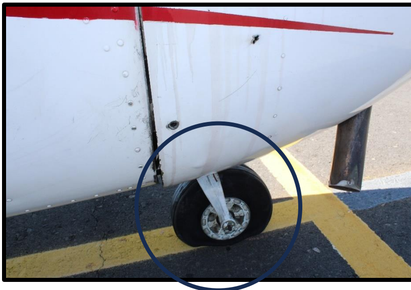
Fotografía No. 3 Cobertor del motor con líquido hidráulico del amortiguador.
