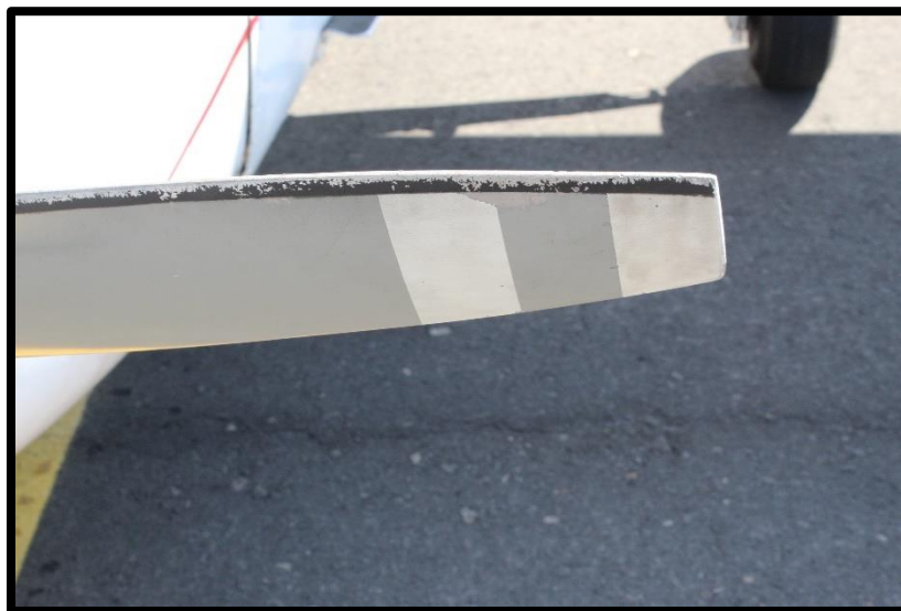
Fotografía No. 7 El aspa 2 de la hélice no se dañó.
