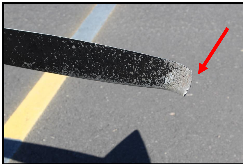
Fotografía No. 5 Daño en el aspa de la hélice
